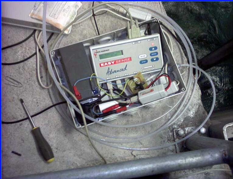
Datalogger per l'acquisizione dei dati di temperatura, conducibilità elettrica e livello idrostatico
