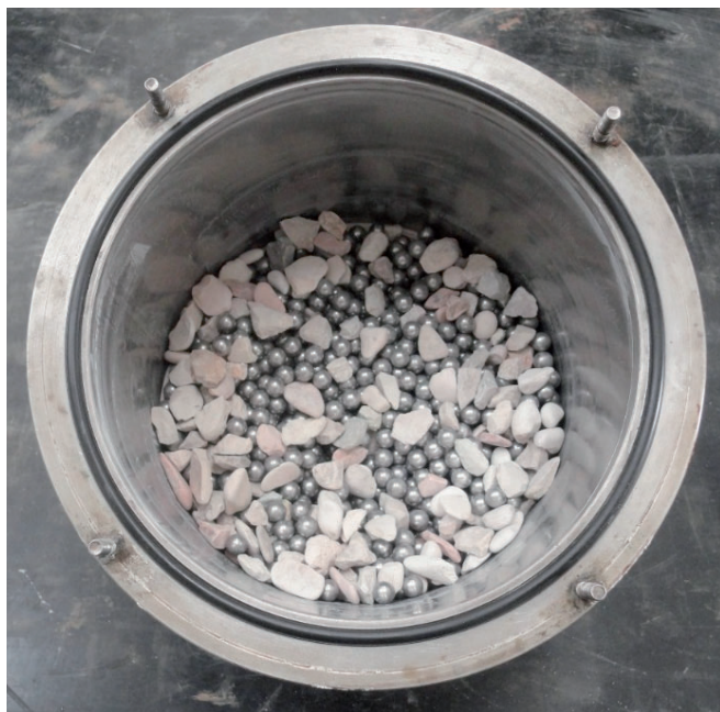
Figura 1 - Micro-Deval (tamburo rotante, campione e carica abrasiva)
