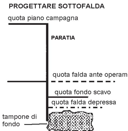
FIGURA 1 - SCHEMA DELLE OPERE PROVVISORIE DI CANTIERE NELLA PROGETTAZIONE SOTTOFALDA. PARATIA DI PALI, PRIMA OPERAZIONE PER REALIZZARE UN PARCHEGGIO INTERRATO. NELLO SCAVO A CIELO APERTO, COL POMPAGGIO SI DEPRIME LA FALDA ACQUIFERA AL DI SOTTO DELLA QUOTA DI SCAVO
