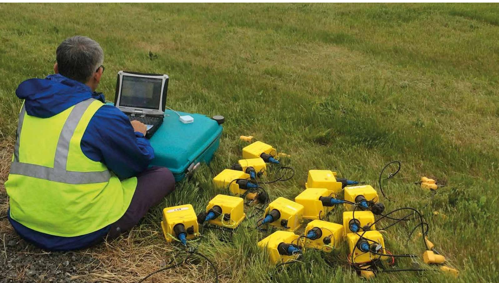
Il nuovo sismografo Geometrics ultra compatto, passivo, wireless, per Vs a elevate profondità, senza più cavi sismici.
