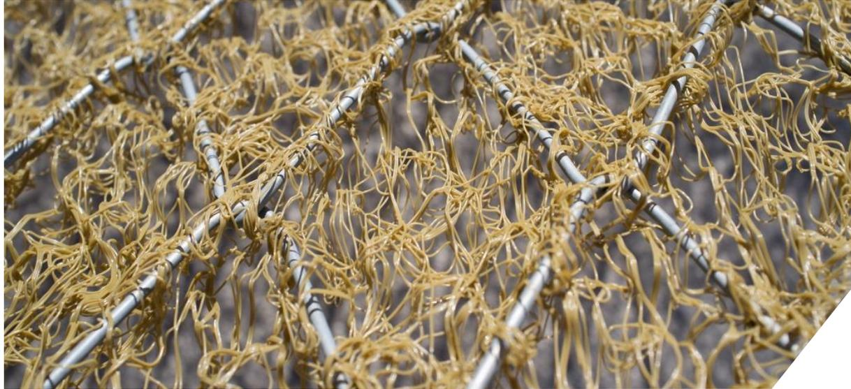
Rete con abbinata una geostuoia in polipropilene estrusa in fase di produzione
