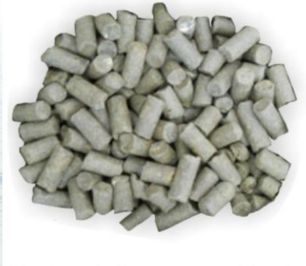
I **cilindretti di montmorillonite** hanno un indice di rigonfiamento formidabile, quindi un'efficace tenuta idraulica.
