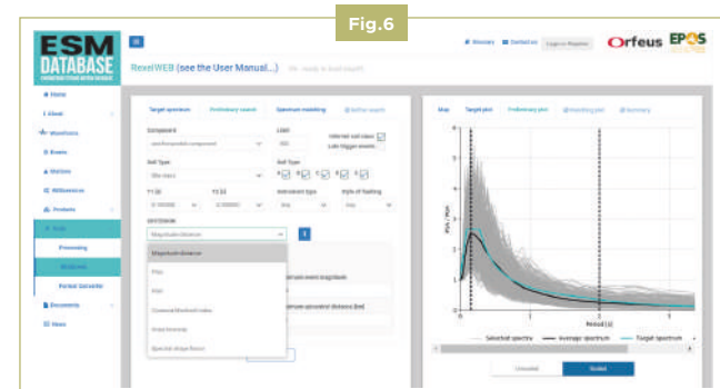
Fig 6: Pannello grafico di REXELweb per l'inserimento dei criteri di selezione e visualizzazione degli spettri ( https://esm-db.eu/#/rexel ).
