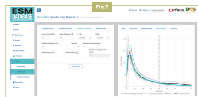
Fig 7: Pannello grafico di REXELweb per l'inserimento dei criteri di spettro-compatibilità e restituzione grafica di un esempio di combinazione ( https://esm-db.eu/#/rexel )
